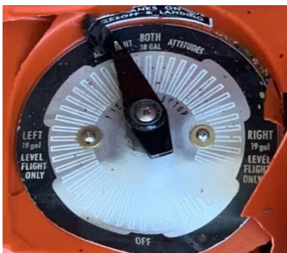
Foto 26: selettore serbatoi carburante.
