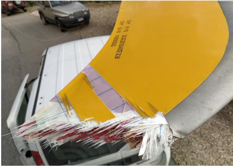
Foto 1: danneggiamenti della pala arancione. I danneggiamenti delle altre 4 pale risultano analoghi a quello mostrato per la pala arancione.
