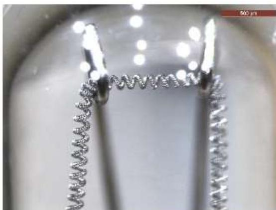
Foto 41: filamento della lampadina 1 relativa alla modalità HDG.
