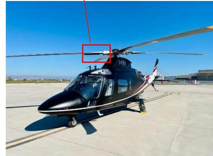
Foto 27: parte di pala di rotore principale e localizzazione esplicitiva su elicottero.
