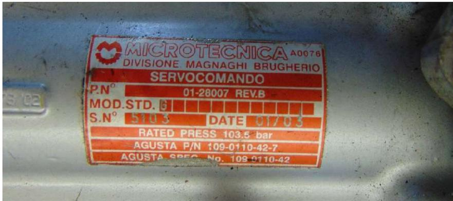
Foto 58: attuatore idraulico P/N 205-28007-00 S/N 5103, targhetta identificativa della sola parte di attuazione.
