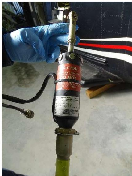
Foto 55: attuatore lineare relativo all'asse di imbardata P/N 401-23-73-905 s/n 97012390.
