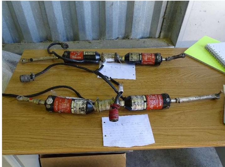
Foto 54: attuatori lineari relativi agli assi di rollio (p/n 401-23-73-909 s/n non leggibile; p/n 401-23-73-909 s/n 99013651) e beccheggi (p/n 401-23-73-908 s/n non leggibile; p/n 401-23-73-908 s/n 00024166).
