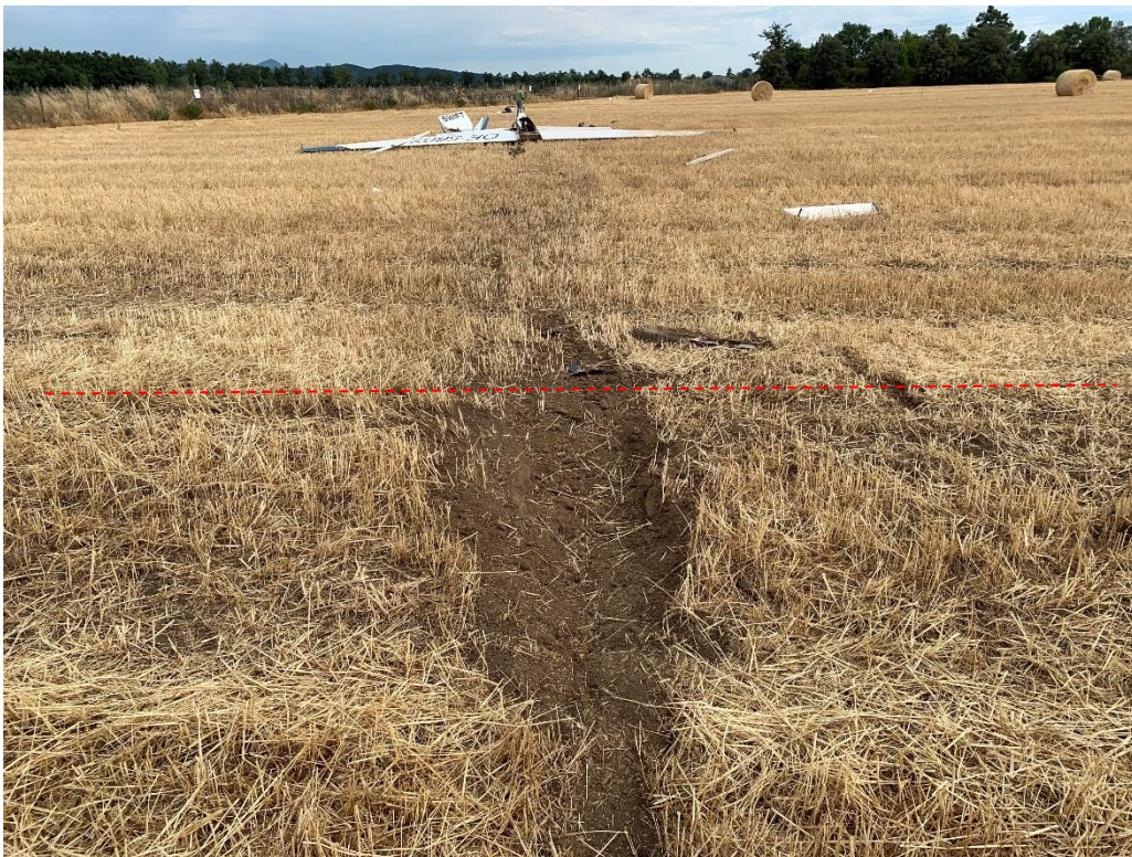
Foto 6: Swift S-1 marche OE-5607 sul luogo dell'incidente e traccia di impatto al suolo.
