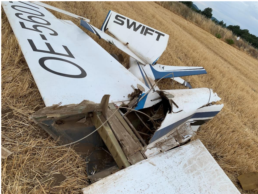
Foto 2: parte centrale della struttura di fusoliera dell'aliante Swift S-1 marche OE-5607.
