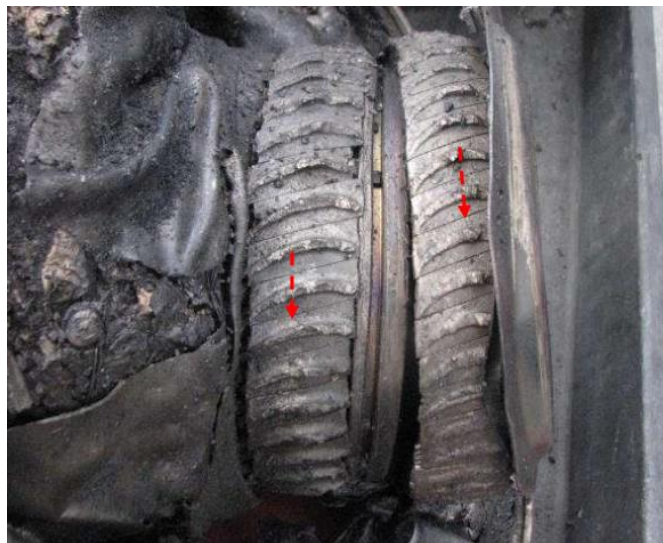
Foto 46: primo e secondo stadio della turbina di potenza (PT).
