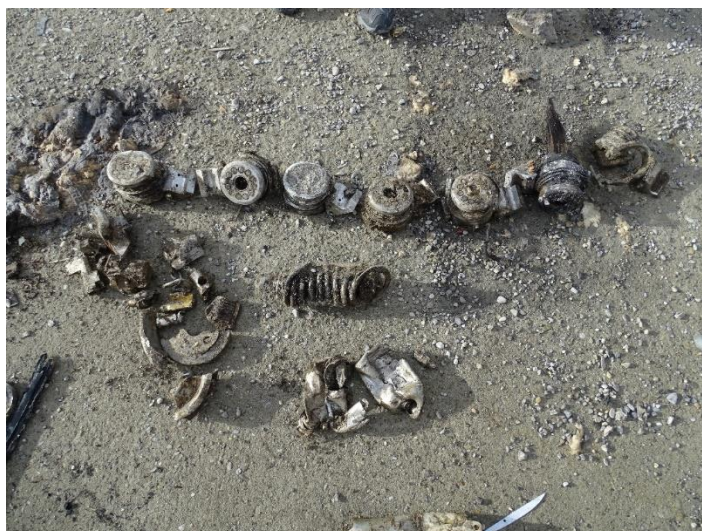
Foto 19: mozzi delle pale dell'elica e parti del regolatore dei giri.
