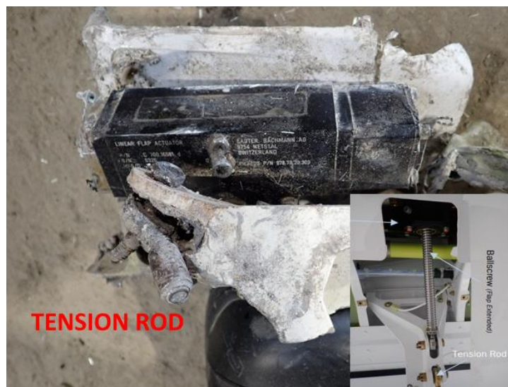
Foto 29: l'attuatore flap rinvenuto con tension rod in posizione retratta. Nel riquadro un attuatore flap posizionato con superfici estese.
