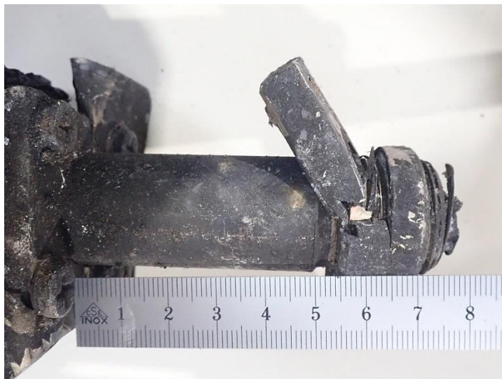
Foto 53: misurazione della estensione del ram (54 mm).
