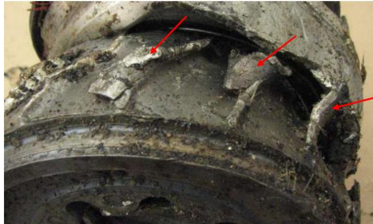
Foto 48: primo stadio del compressore.
