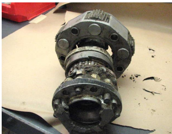
Foto 49: propeller shaft con il secondo stadio del riduttore.
