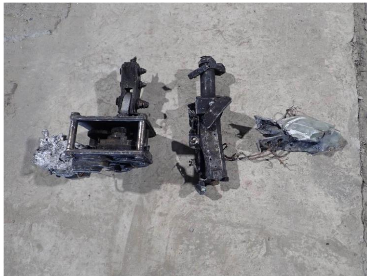
Foto 51: l'attuatore del pitch trim . Gearbox (a sinistra) e jack screw assembly (a destra).
