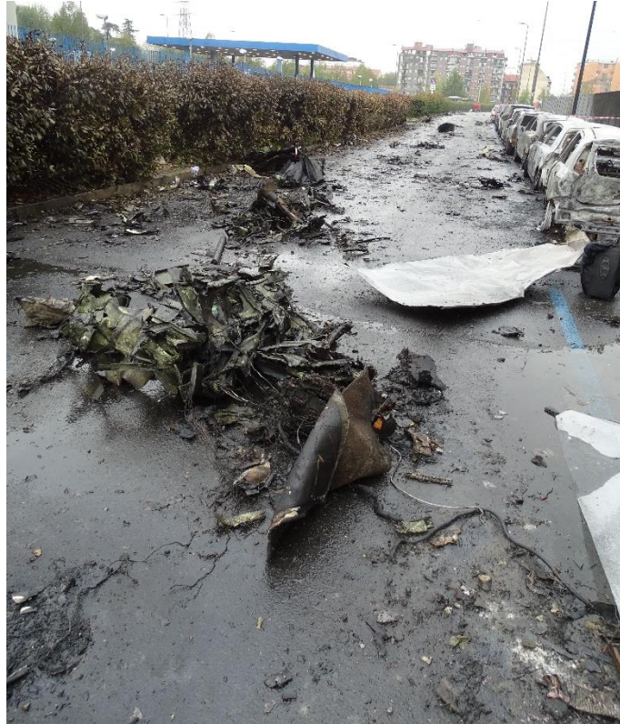
Foto 17: frammenti di fusoliera collegati per mezzo dei cavi dei comandi di volo.
