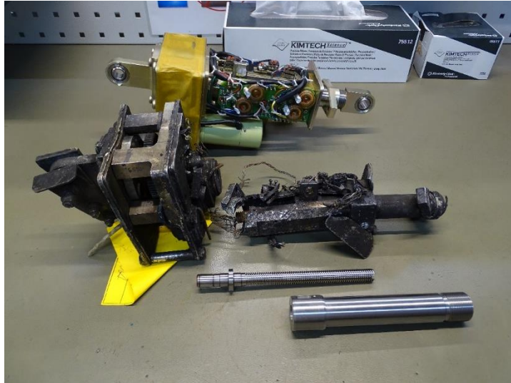
Foto 52: l'attuatore del pitch trim . Gearbox (a sinistra) e jackscrew assembly (a destra) raffrontati a analogo componente efficiente.
