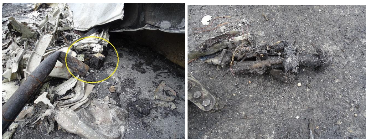
Foto 20 e 21: rinvenimento di parti dello stabilizzatore e dell'attuatore pitch trim in prossimità del punto di impatto.
