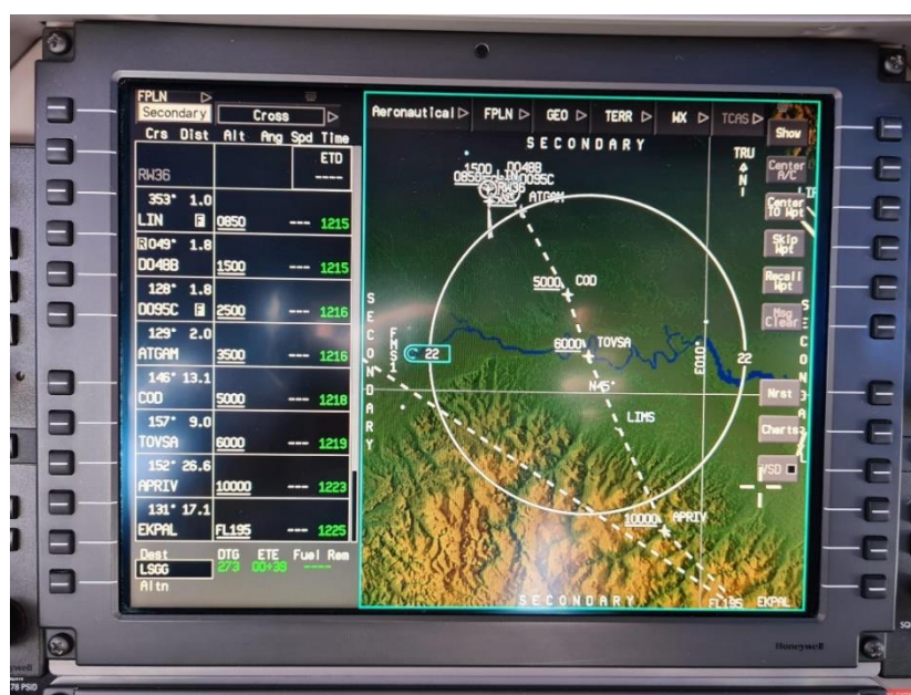
Foto 6: immagine del situational awareness display del PC-12/47E con avionica analoga al velivolo coinvolto nell'incidente recante il FPLN con SID TOVSA 5A e transizione EKPAL 5A, priva di discontinuità.
