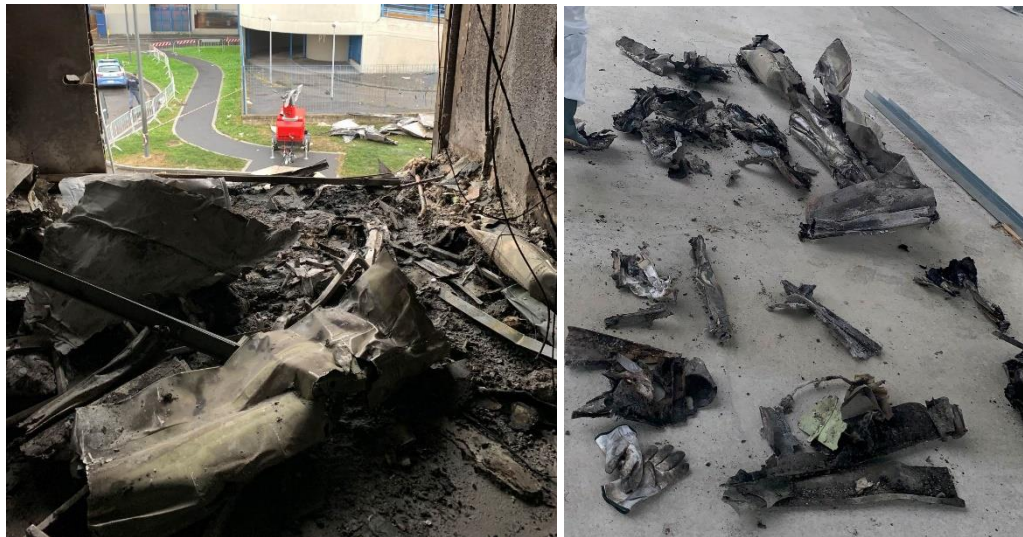
Foto 15 e 16: frammenti di semiala destra e flap destro rinvenuti al primo piano (foto a sinistra) e parzialmente ricomposti (foto a destra).
