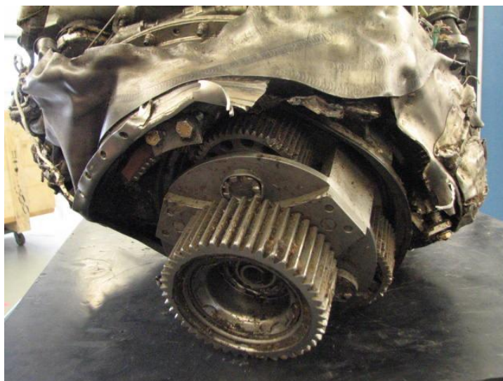
Foto 45: vista frontale con primo stadio del riduttore dei giri.
