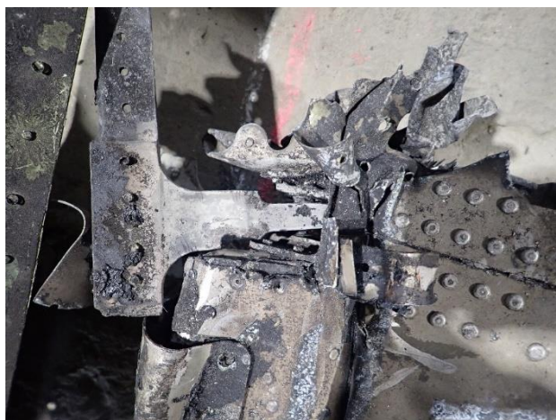
Foto 34: particolare del punto di connessione dell'elevatore sinistro allo stabilizzatore orizzontale.
