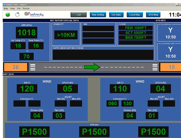
Figura 23: screen shot sistema AWOS (automatic weather observation system) ENAV Linate recante i dati dell'ATIS in vigore alle 11.04' (informazioni "Y" delle 10.50')
