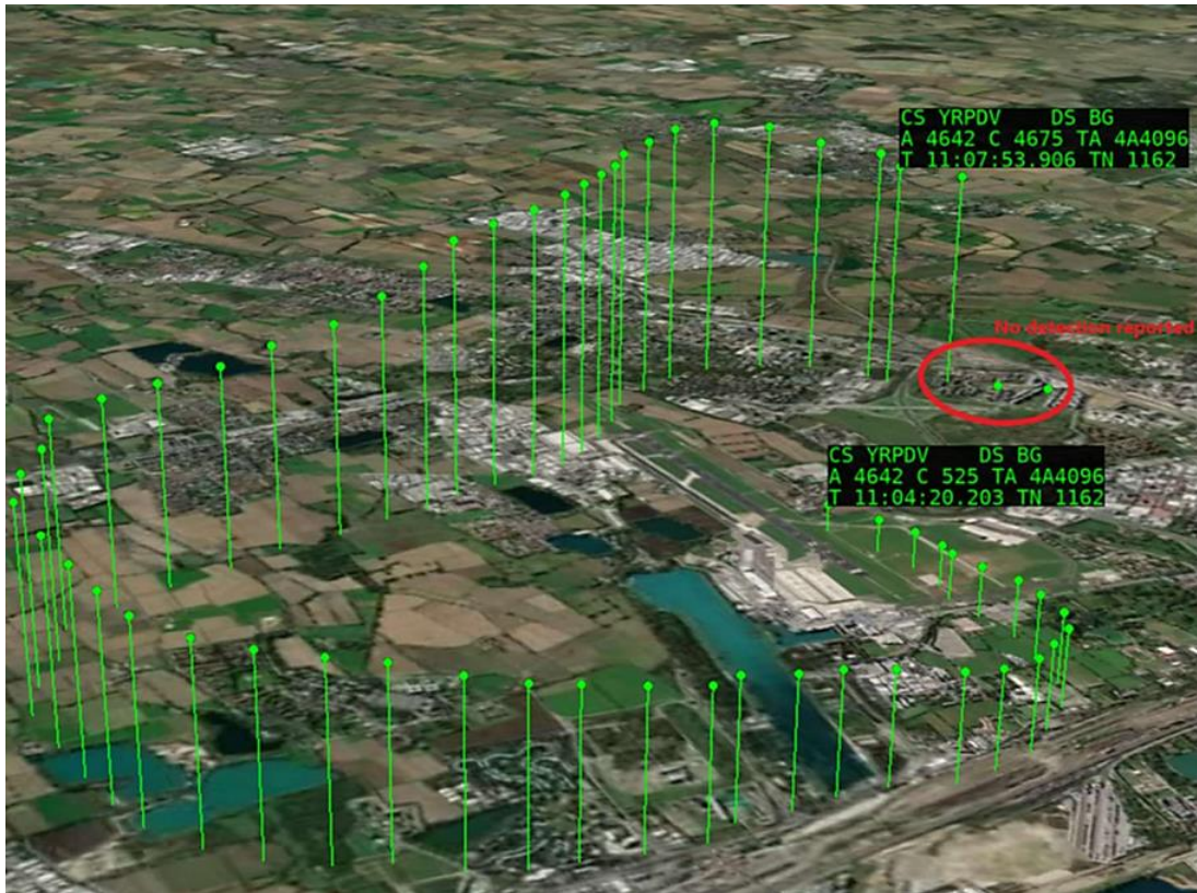
Figura 36: radar Bergamo, ricostruzione 3D della traiettoria di volo (elaborazione ENAV).
