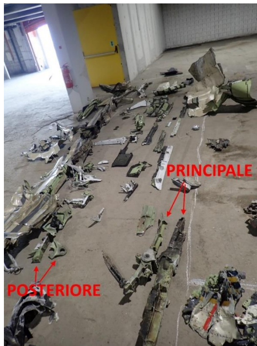
Foto 24: ricostruzione dell'ala sinistra con evidenziati dalle frecce rosse i punti di attacco dei longheroni con la fusoliera.
