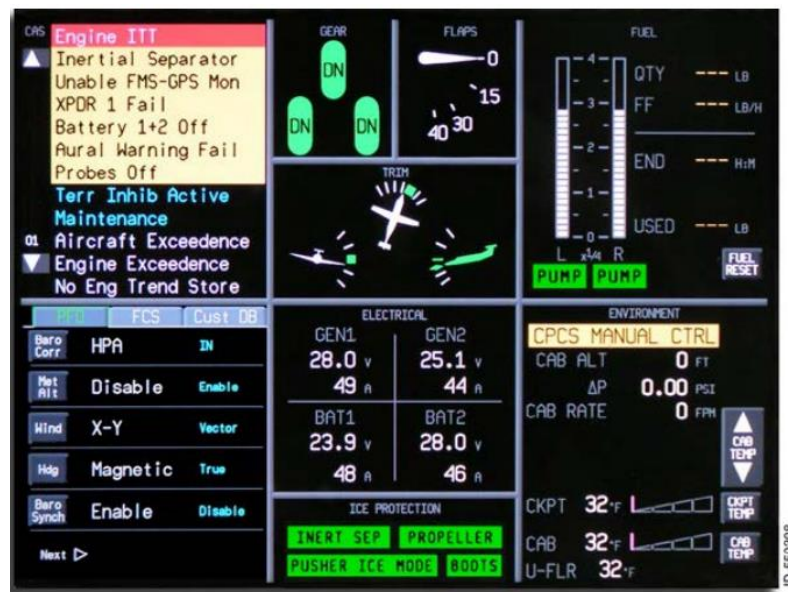
Figura 16: esempio di visualizzazione del system display e CAS (da Honeywell Primus Apex Integrated Avionics System for the Pilatus PC-12 NG Pilot's Guide Rev. 20 del 6.1.2020).
