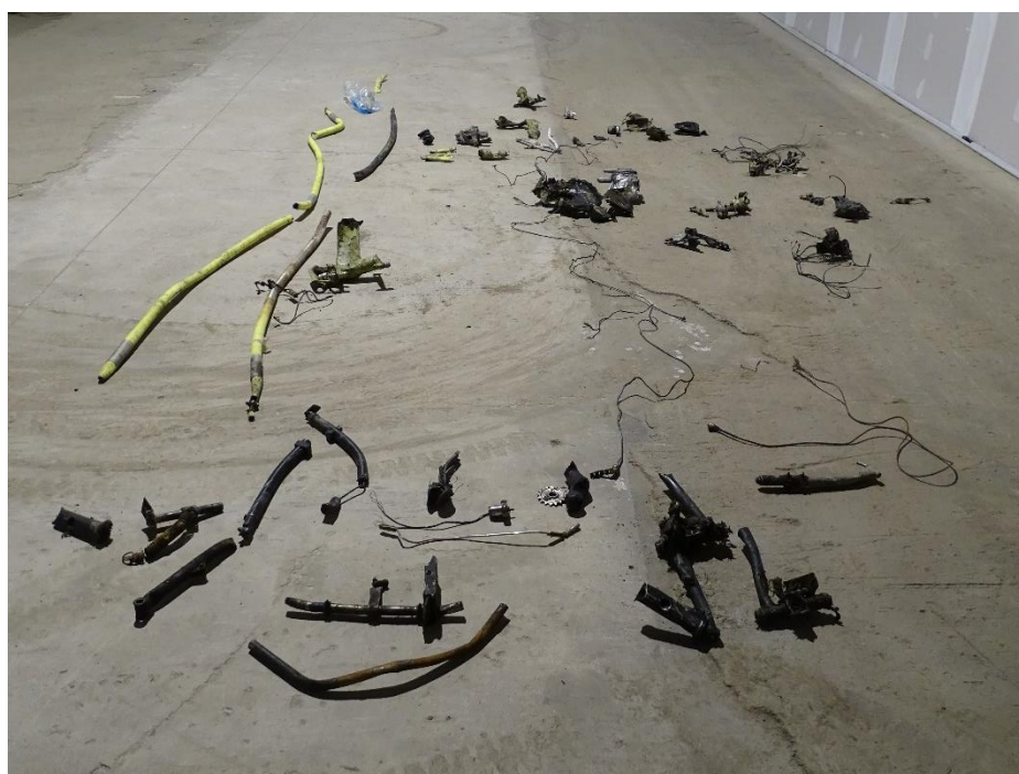
Foto 35: frammenti dei comandi e delle aste di comando.
