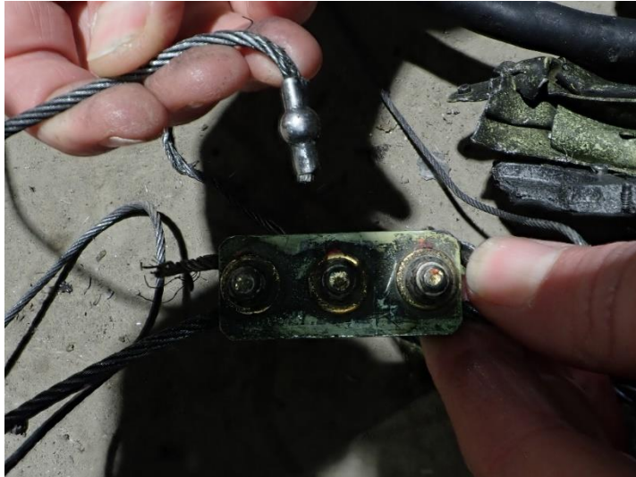
Foto 39: il terminale a sfera del cavo del rudder relativo al punto di fissaggio evidenziato dalla foto precedente.
