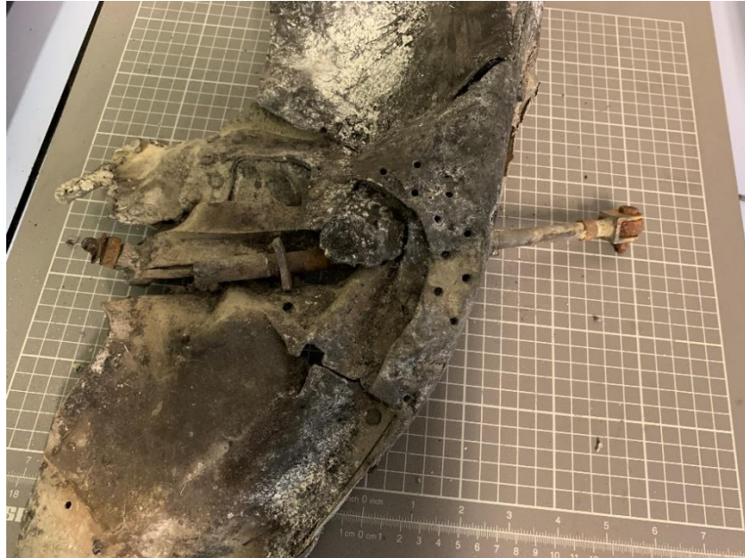
Foto 65: resti dell'attuatore del rudder trim ; visibile la porzione dell' operating rod e del push rod .
