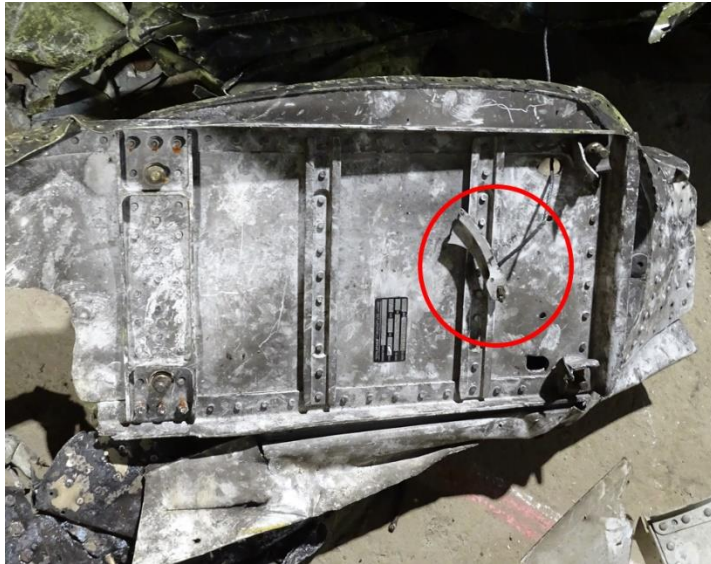
Foto 40: parte del braccio del quadrante di controllo del timone di direzione vincolato al secondo dei due cavi di rudder.
