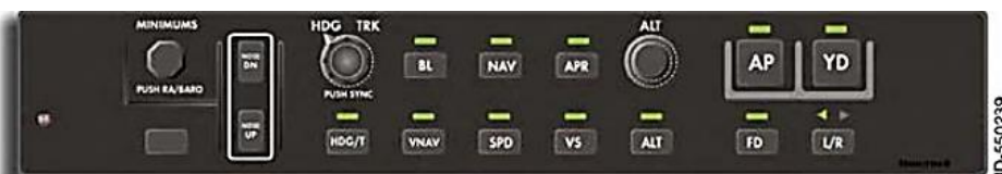
Figura 17: pannello flight controller mediante il quale si effettuano le selezioni dell'AFCS.
