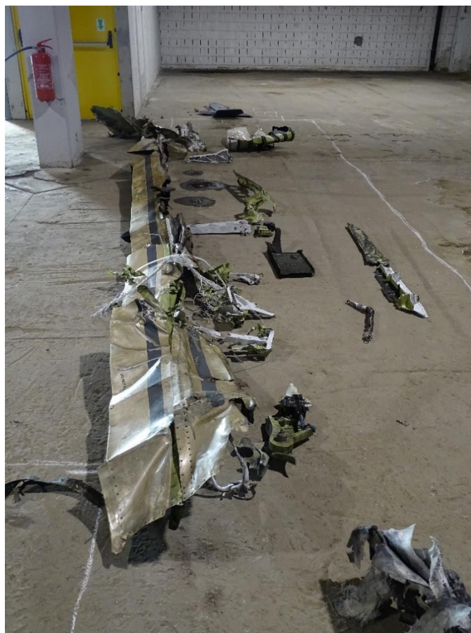
Foto 25: ricostruzione del flap sinistro.
