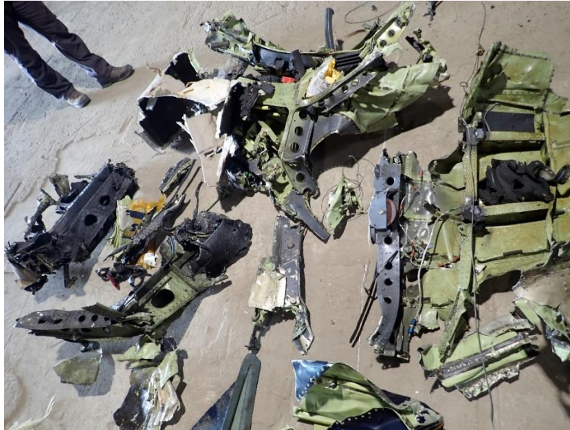
Foto 23: parti della porta del vano di carico e di fusoliera adiacenti.
