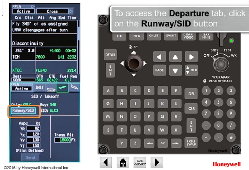
Figura 18: procedura di inserimento di una SID, parte delle procedure che il pilota deve effettuare prima della partenza (fonte Honeywell).
