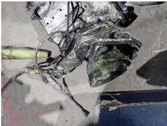
Foto 41: frammento del comando dell'elevatore ( elevator hinge ).
