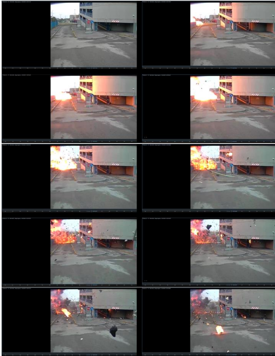
Foto 75: la sequenza dell'esplosione in seguito all'impatto con proiezione dei frammenti dell'aeromobile.
