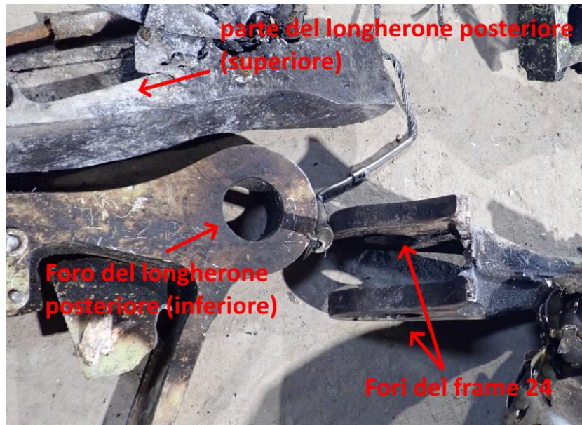
Foto 27: frammenti del punto di giunzione inferiore posteriore della semiala destra alla fusoliera.
