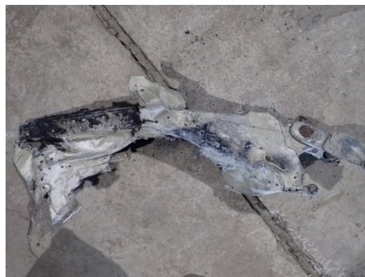
Foto 32: punto di connessione sinistro di stabilizzatore ed elevatore.
