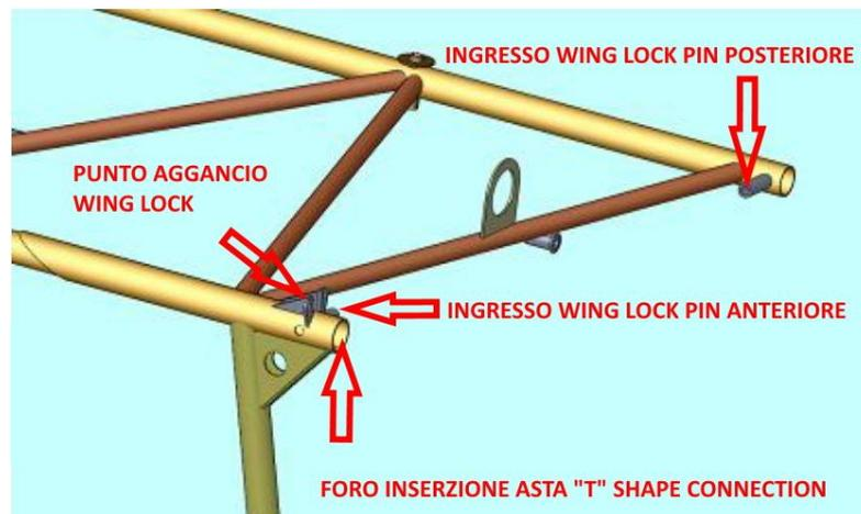
Figura 2: struttura metallica in fusoliera denominata *cabane*, con in evidenza i punti di attacco della semiala (lato semiala sinistra).
