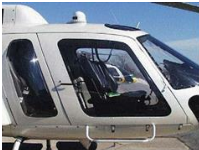
Foto 7: installazione high visibility door (fonte Airbus Helicopters).
