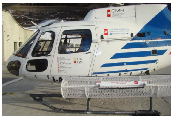
Foto 2: installazione dell' utility basket (fonte GMH).
