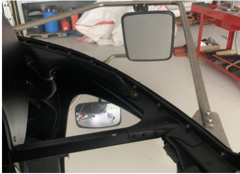
Foto 3: vista laterale e inferiore tramite specchio laterale e cargo mirror .
