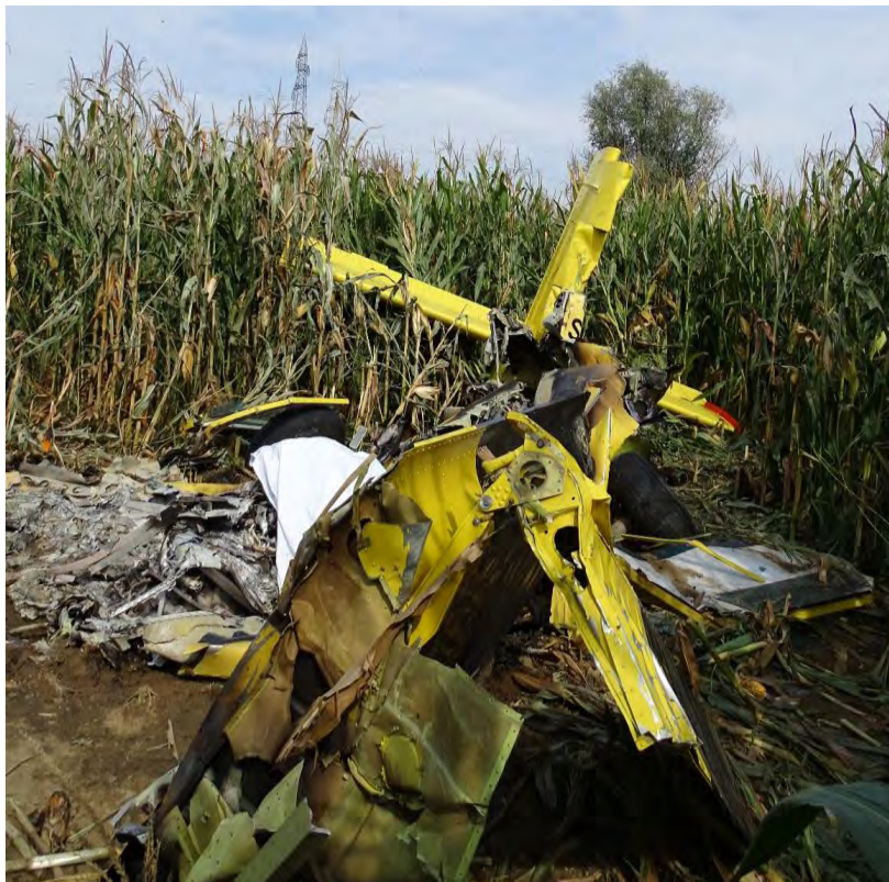
Il Pilatus PC-6 B2/H4 marche T7-SKY precipitato al suolo dopo la collisione, in volo, con un paracadutista.
