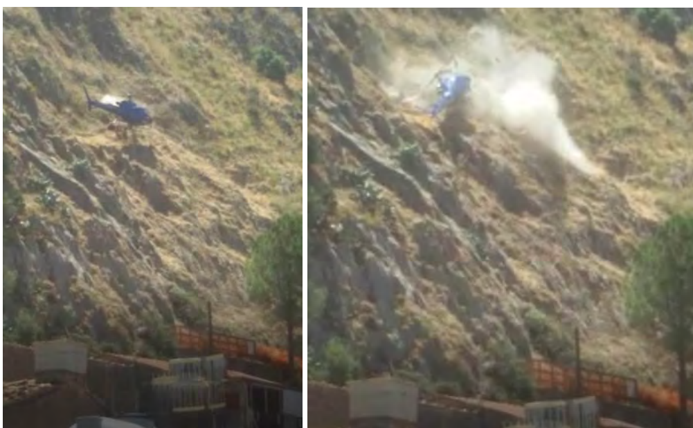
Fermo immagine dal video dell'incidente: fase di contatto del rotore principale dell'elicottero marche I-MLTA con la parete rocciosa (a sinistra), fase di caduta dell'elicottero (a destra).
