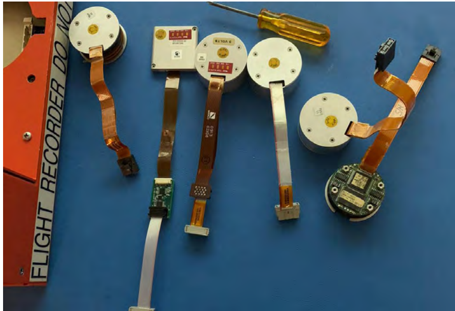
Differenti tipo di CSMU 80 installate nei recorder L3Harris.
