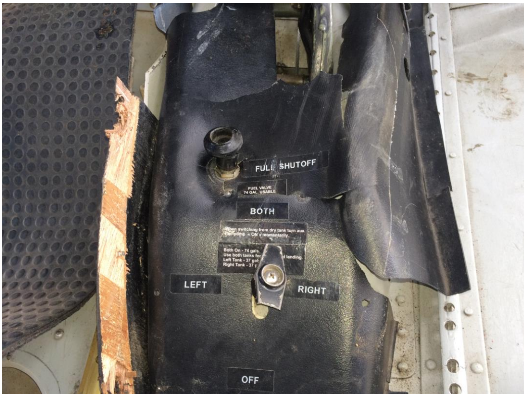
Foto 5: dettaglio del selettore dei serbatoi del carburante.
