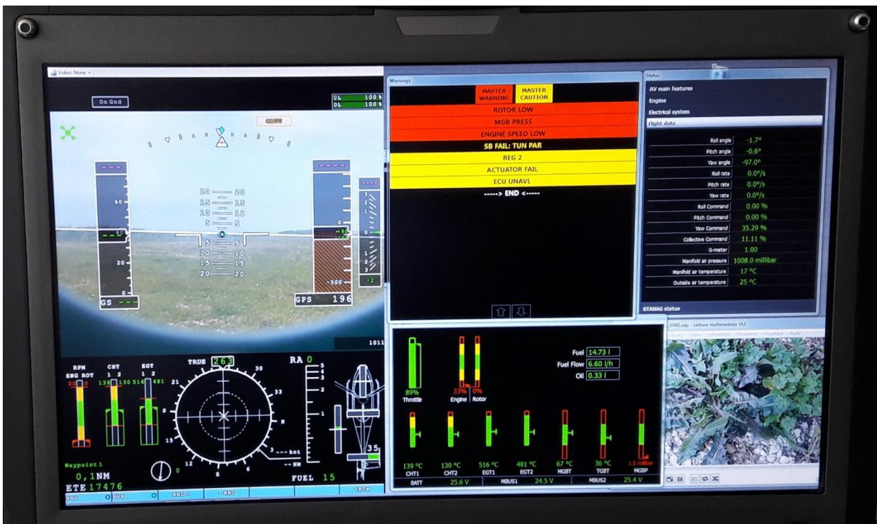
Foto 4: esempio di visualizzazione dei dati sul pannello di controllo presente nella ground control station .
