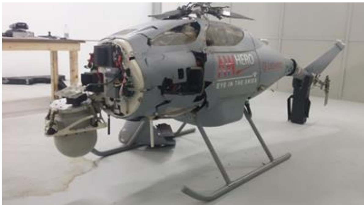
Foto 1: AWHERE marche I-UASF, con i danneggiamenti subiti in occasione dell'incidente.
